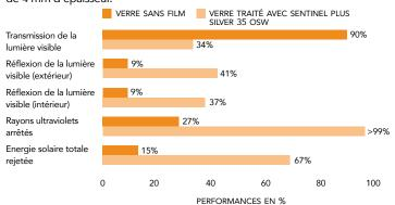
Les résultats refletent une installation à l'extérieur d'un simple vitrage transparent de 4 mm d'épaisseur et d'un double vitrage transparent de 4mm+4mm.
