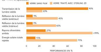
Les résultats refletent une installation à l'intérieur d'un simple vitrage transparent de 4 mm d'épaisseur et d'un double vitrage transparent de 4mm24mm.
